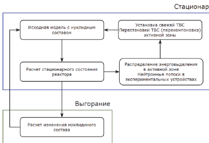
Рис. 2. Блок-схема определения параметров активной зоны в MCU-PTR
